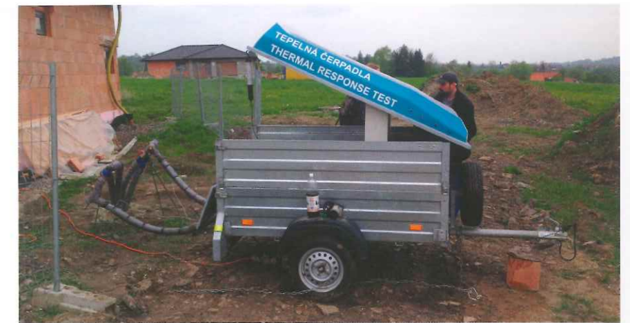
Terénní měření tepelné odezvy horninového prostředí ve vrtu
